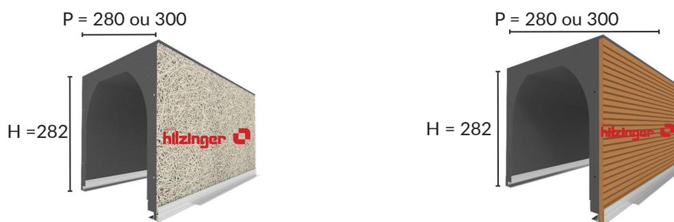
Ces coffres linteau vides sont proposés en parement Fibralth ou Brique avec une profondeur de 280mm ou de 300mm (pour une hauteur de 282mm) et des largeurs allant de 600 à 4500mm. Afin de respecter l'[avis technique 16-13/676](#), ceux-ci sont automatiquement équipés de renforts à partir de 1600mm de largeur.
