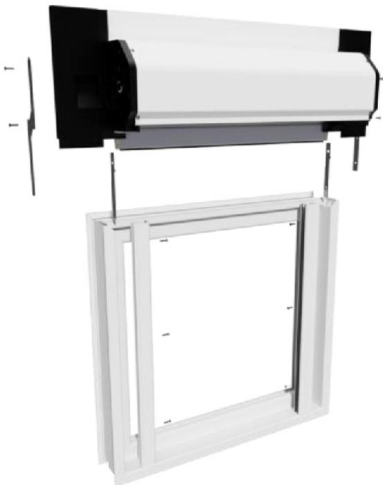
Coffre de volet roulant rapide à poser sur la menuiserie : fixation par 2 pattes dans les coulisses, elles même posées sur les tapées menuiseries et 2 pattes latérales.
